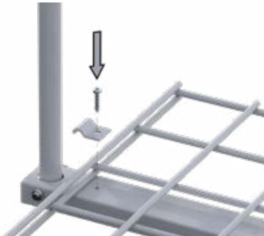
8. Фиксация болтом с гайкой двух сетчатых полок на одном уровне между собой
