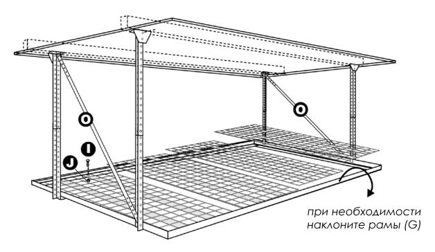
Затяните болты (M) и гайки (N) в каждом углу опорных рам. Скрепите проволочные решётки (A), как показано на рисунке, при помощи 4 болтов (I) и гаек (J) для каждого конца решётки. Убедитесь, что все гайки, болты и винты затянуты.
