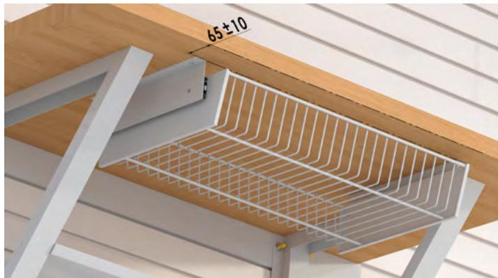
**ВАЖНО!** Саморез должен быть короче длиной, чем толщина столешницы.
