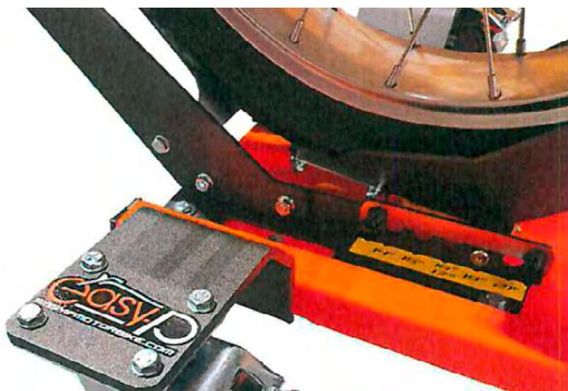
16. Заезжайте на мотопаркер передним колесом, убедившись, что оно попадает ровно в захват. Продолжайте до блокировки захвата. Включите стояночный тормоз.
