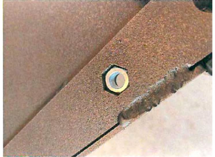
4. Установите колеса (Б-9) на поддерживающий кронштейн (Б-8) с помощью 4 болтов М8х20 (Б-12), 4 шайб (Б-16) и 4 фланцевых гаек (Б-18). Повторите для остальных 3 колёс. Установите поддерживающие кронштейны на платформу с обеих сторон и затяните фланцевыми гайками М8 (Б-18)
