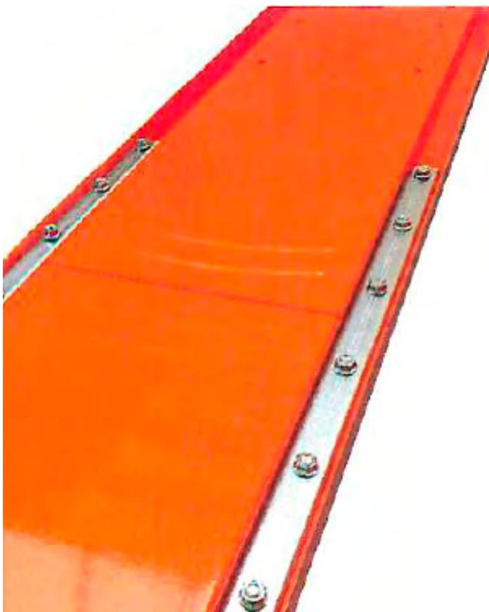
3. Переверните платформу, чтобы U-образные соединитель оказался на полу. Установите резиновую аппарель (А-3), используя 2 винта М8х25 (А-5), шайбы  $\varnothing 8 \times 24$  (А-7) и гайки М8 (А-8).
