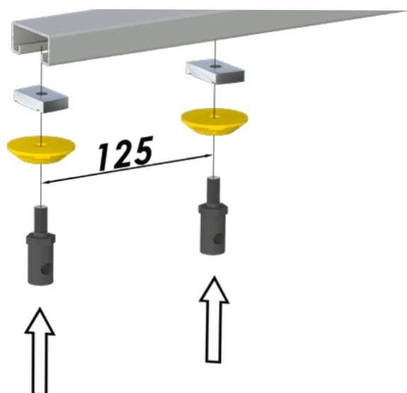
3. Установка собранного подвеса на рельс с помощью крепежа
