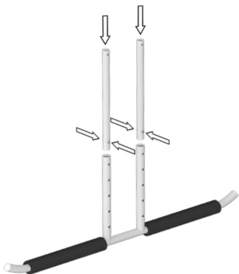
2. Установка круглых соединителей на потолочный рельс
